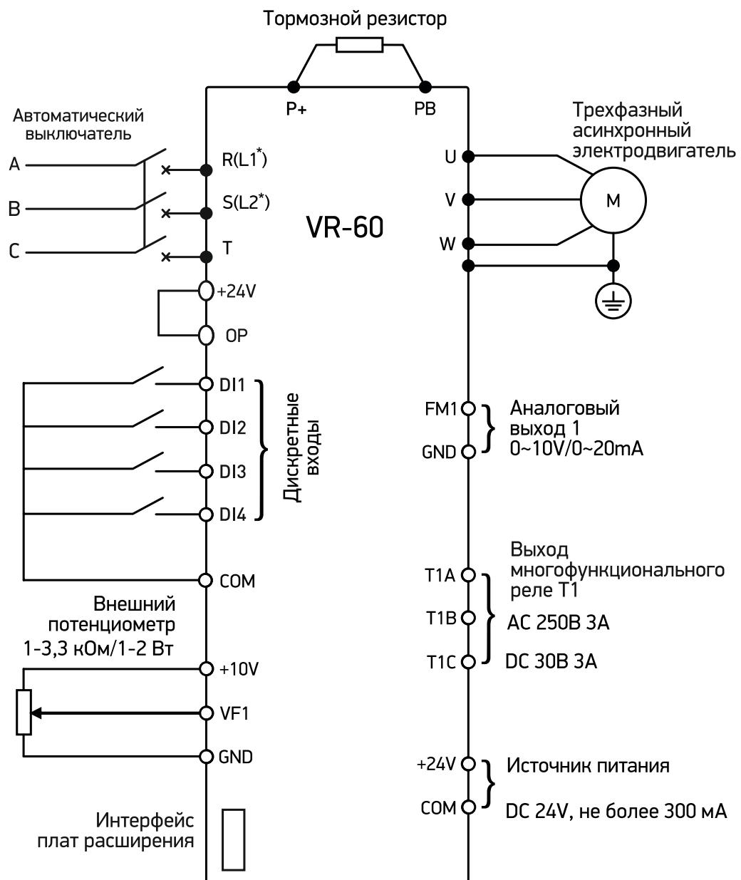
\*L1, L2 - для подключения к однофазному источнику питания 1ф 220В.
