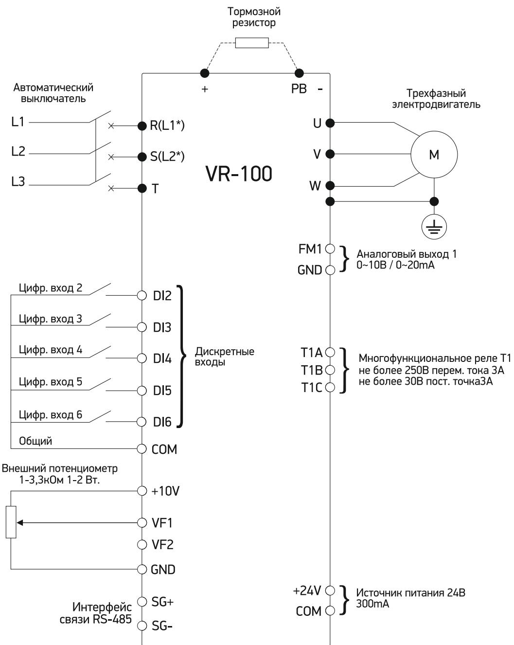
\*L1, L2 - для подключения к однофазному источнику питания 1ф 220В.
